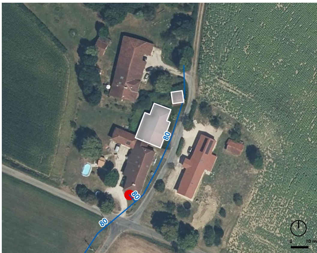
Réseau d'alimentation en eau potable, avec poteaux d'incendie
